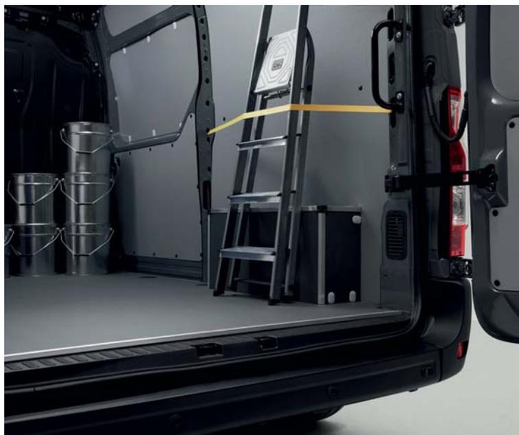
Parois latérales et plancher antidérapant polypropylène 6 mm
